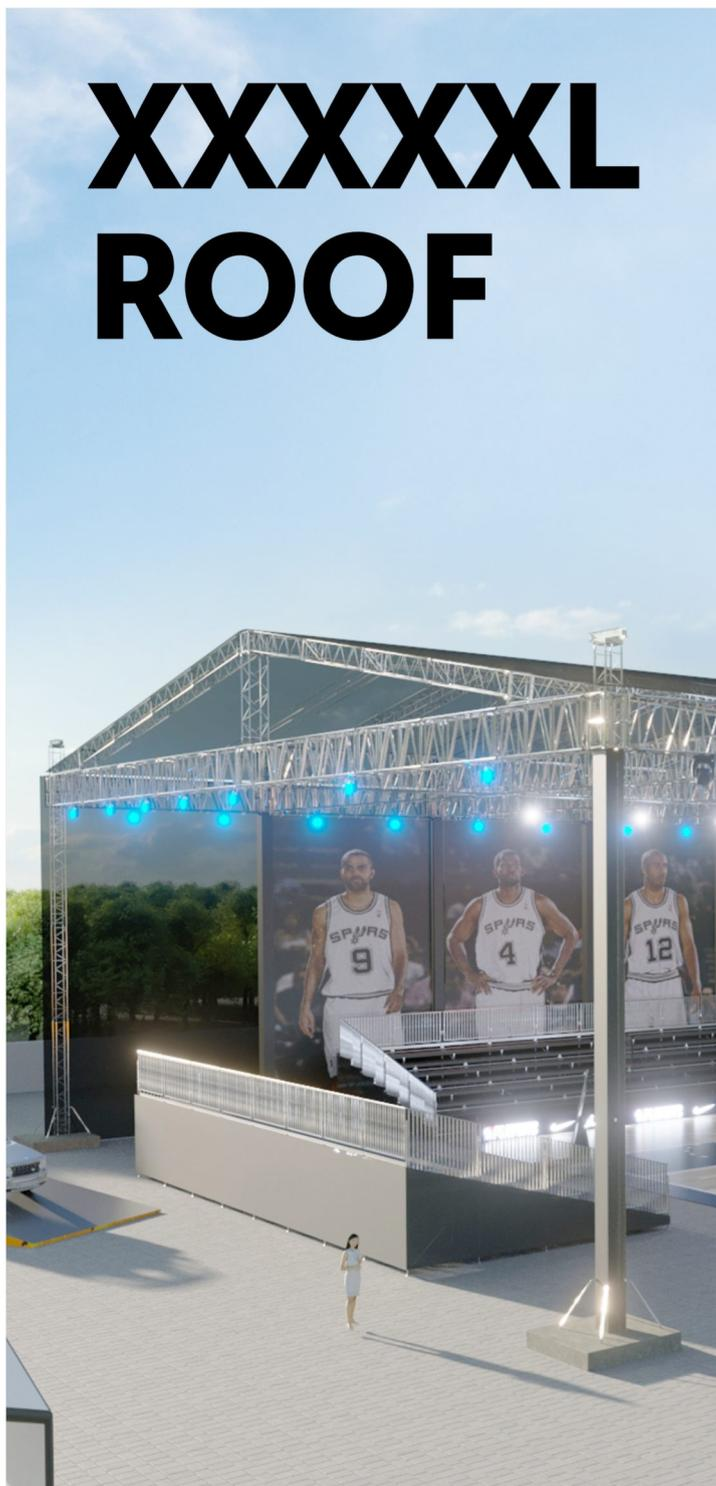
**СТ ROOF (XXL)** – грандиозная крышная система, периметр которой собирается на базе фермы В100 и дополняется двускатным конструктивом из фермы В52. Конструкция может создаваться в нескольких размерах с пролётом до 30 м. Исполинский рост конструкции достигает 12 метров между подиумом и основным периметром. Общий габарит по длине конструкции ограничен лишь возможностями площадки и может достигать 50 и более метров.
